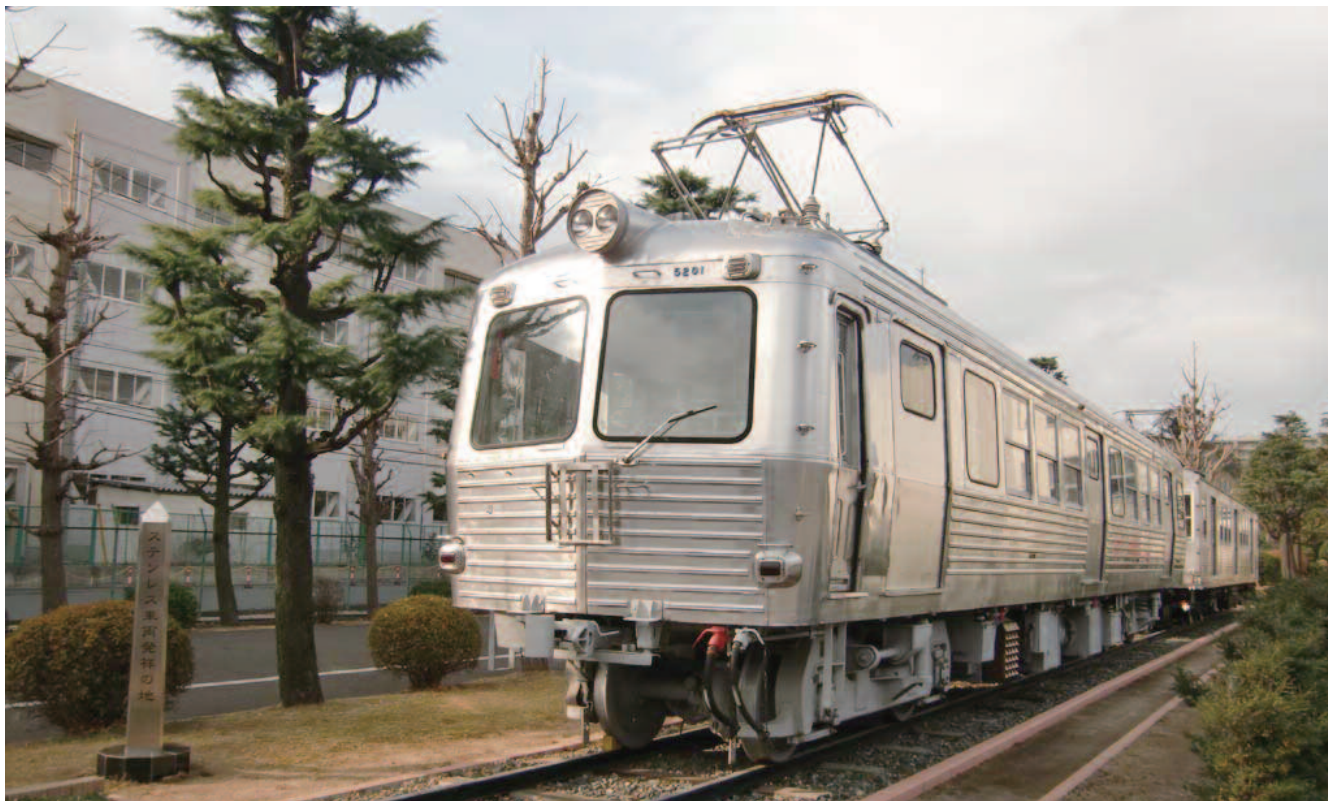
図1 日本初のステンレス鋼製車両群
