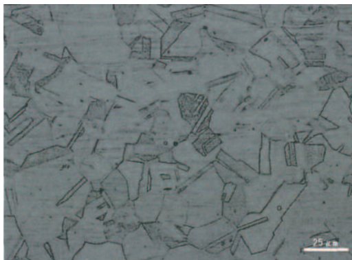
図12 試験体8-12のレーザスポット溶接部断面上部
