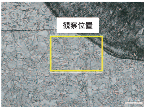
図13 試験体8-12のレーザスポット溶接部断面下部
