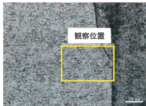
図8 試験体15-8のレーザーポット溶接部断面下部
