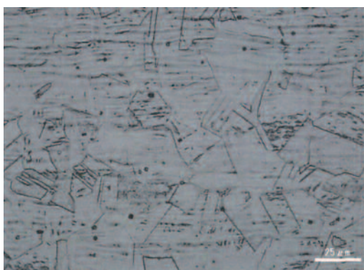
図7 試験体15-8のレーザーポット溶接部断面上部
