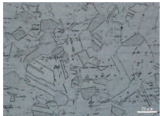
図9 試験体15-8のレーザーポット溶接部断面下部
